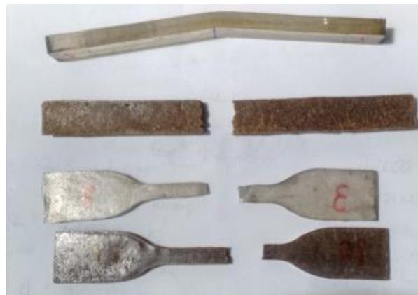
**Figura 3.** Corpos de prova de tração e flexão do compósito e do policarbonato puro.
