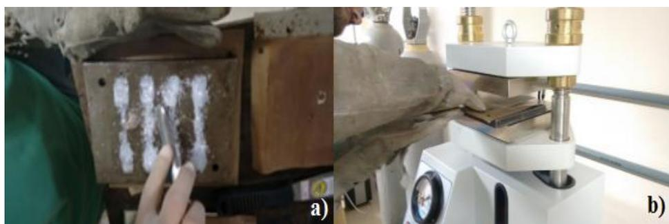
**Figura 2.** Policarbonato sendo depositado no molde (a) e, em seguida colocado na prensa (b).
