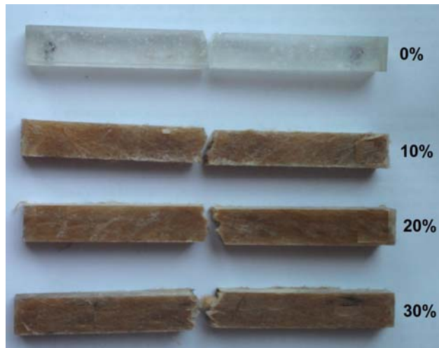
Figura 4. Aspecto dos corpos de prova rompidos por impacto Charpy.
