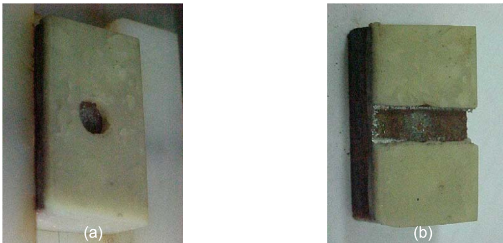
Figura 1. Condição das amostras testadas com jato d'água: com defeitos na forma de bolha (a) e sulco (b).
