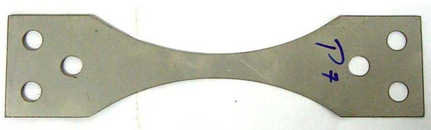
**Figura 1.** Corpo-de-prova utilizado nos ensaios de tração e de fadiga. Comprimento total de 200mm, espessura de 1mm, largura mínima de 12,7mm.
