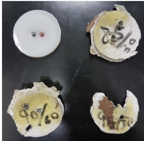
Figura 2. Amostras A00, A85, A90 e A95 (da esquerda para a direita e de cima para baixo, respectivamente) após os testes balísticos.
