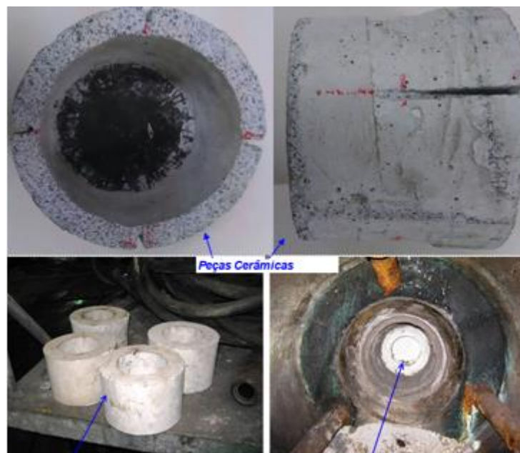
Figura 3. Dispositivo utilizado para isolamento das ventaneiras.
