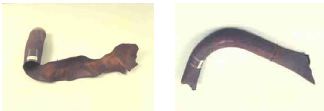
Figura 1. Vista geral do downcomer que rompeu em serviço.
