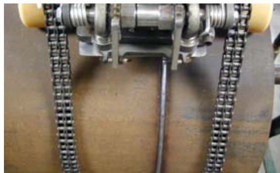
Figura 11: Cordão de solda sobre tubo realizado pelo robô orbital
