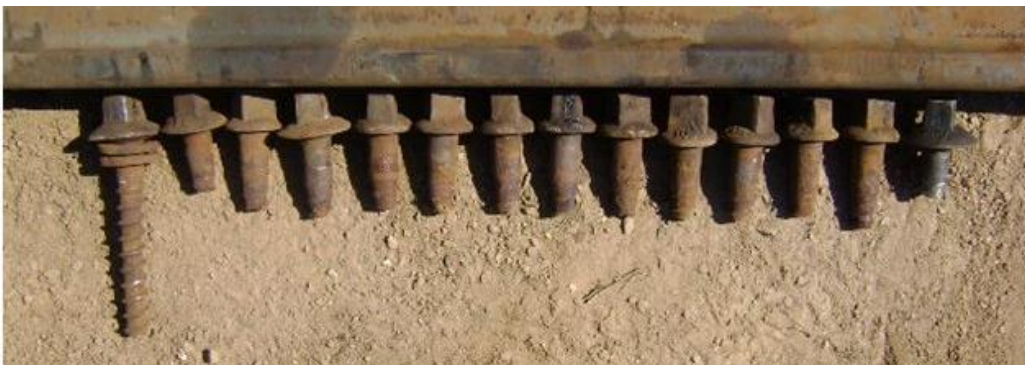
Figura 1. Fotografia de parafusos Tirefond fraturados em serviço.
