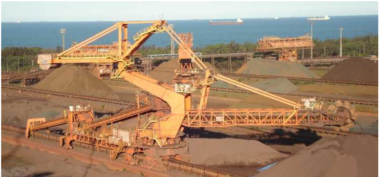
Figura 1. Empilhadeira Recuperadora de roda de caçamba – Porto de Tubarão em Vitória
