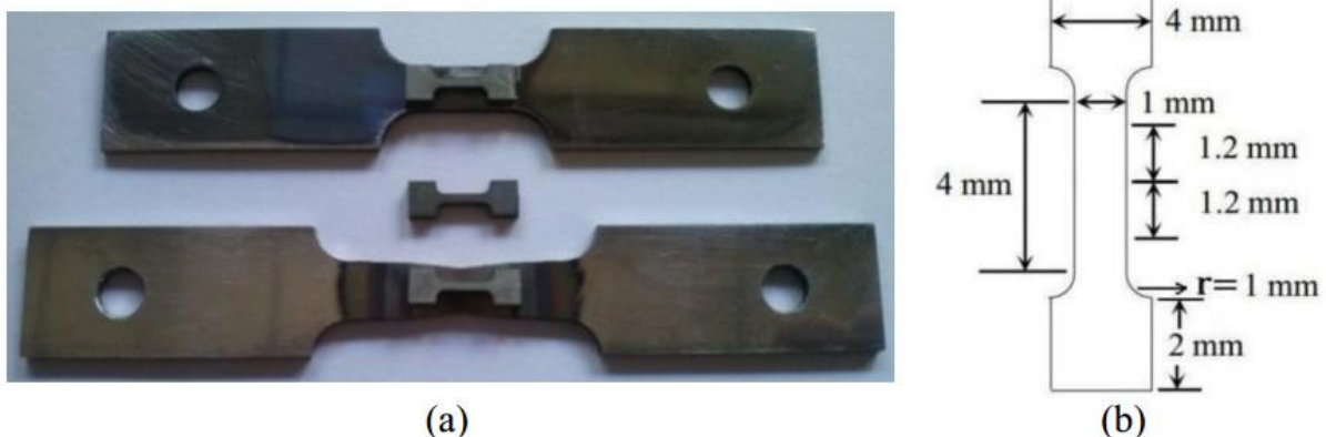
Figura 3. Corpo de prova sub-size para ensaio mecânico. (a) Comparação entre corpo de prova ensaiado na Gleeble e corpo de prova sub-size e (b) Desenho do corpo de prova sub-size com as devidas dimensões.
