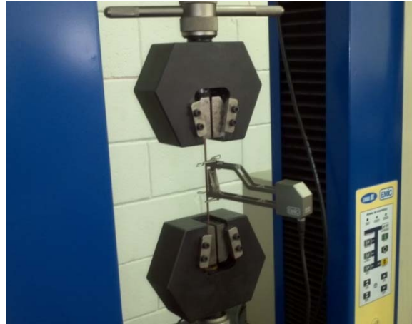
Figura 7. Teste de tração da amostra do fio de cobre com uso de extensimetria.
