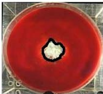
Figura 3 – Exemplo de imagem da área delimitada pelo software Image Tools para a determinação do tamanho do olho da pluma.
