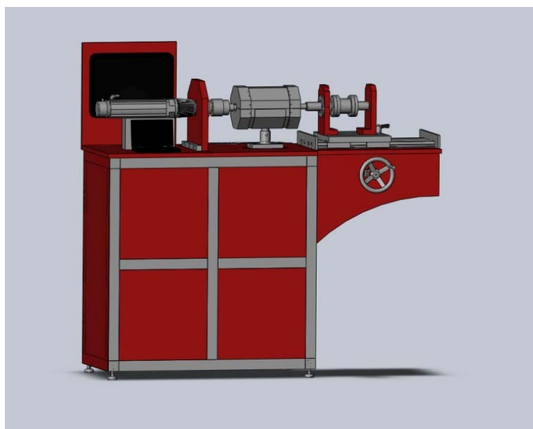
Figura 2. Desenho de uma máquina de torção a quente preparada para fazer simulação física do processo industrial.
