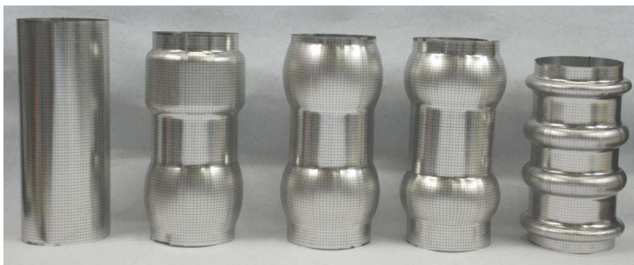
Figura 4 – Corpos de prova após a expansão por pinças nas diferentes ferramentas.
