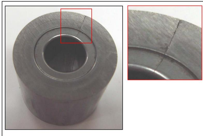
**Figura 3:** Trincas radiais no núcleo de metal duro.
