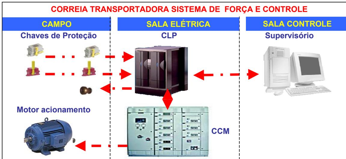
Figura 4: Detalhe típico sistema de força e controle de correias transportadoras
