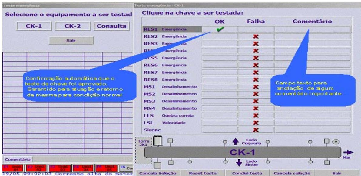
Figura 7: Tela supervisório seleção chave proteção após execução passo 3
