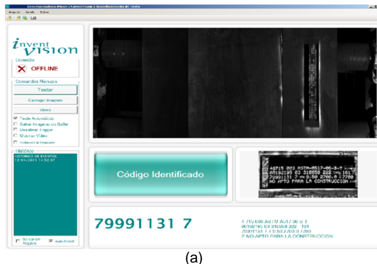
Figura 3. (a) Imagem de uma peça metálica rotacionada e de difícil visualização. No canto inferior direito é mostrada a região de interesse após o processamento. Além dos caracteres terem se tornado legíveis a rotação da peça foi corrigida.
