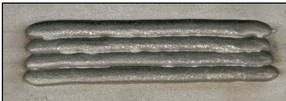
**Figura 4.** Aspecto superficial de soldas de revestimento MIGP-CCEN,  $W_f = 8,5$  m/min.
