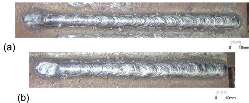
Figura 5. Aspecto do cordão de solda utilizando eletrodo E6013 com velocidade de 2,5mm/s, corrente de 150A e tensão de referência de 20V (a) e corrente de 180A e tensão de referência de 21V (b).
