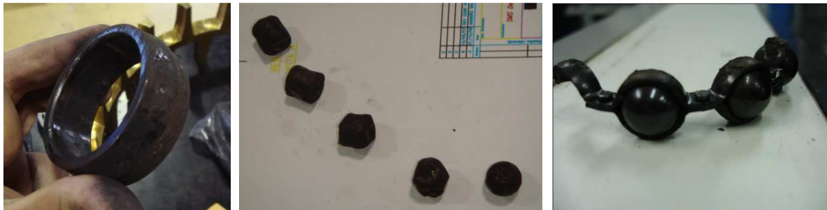
Figura 3 – Modos de falha típicos de rolamentos instalados em rolos guia. (1,2)
