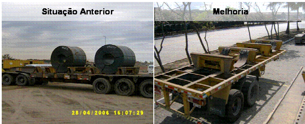
Figura 8: Alteração no modelo de carretas usadas no carregamento das barcaças
