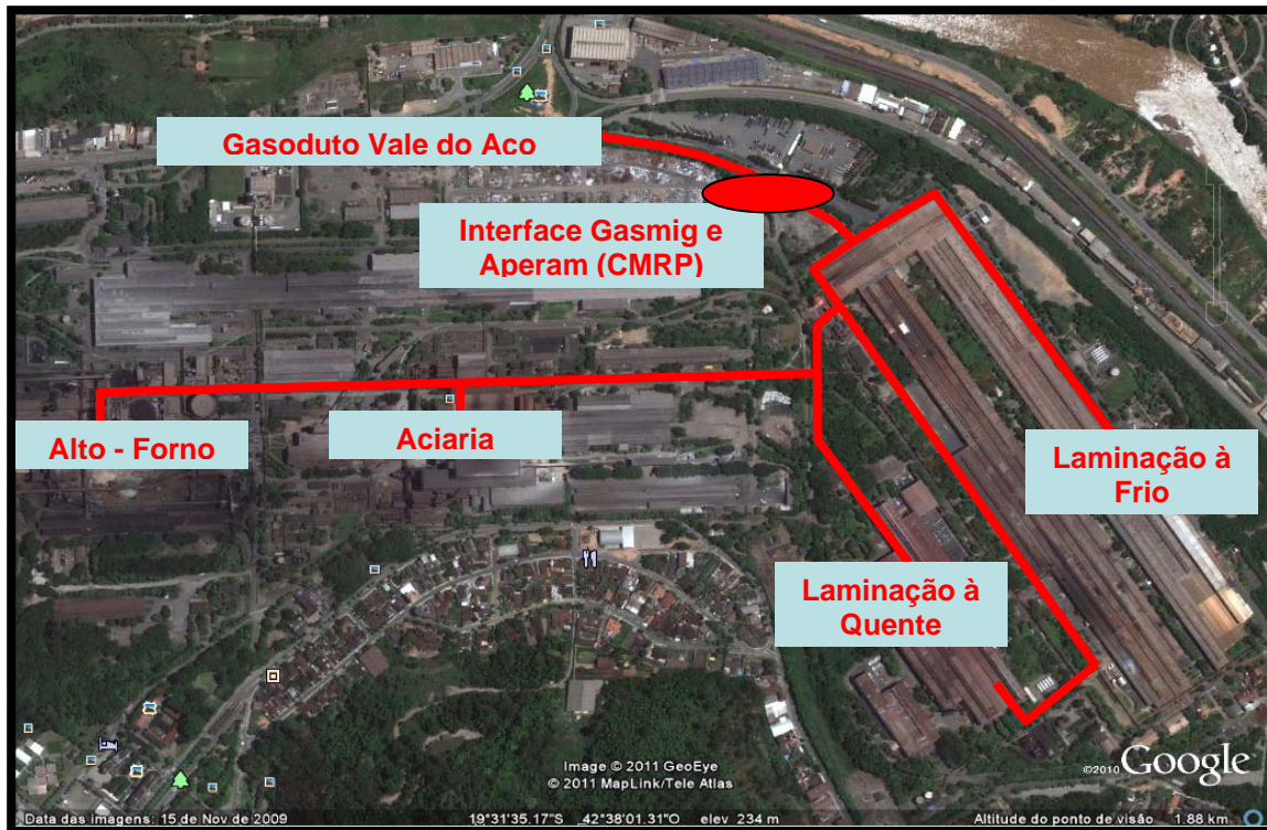
Figura 4. Rede geral de distribuição de GN na planta da Aperam South America.
