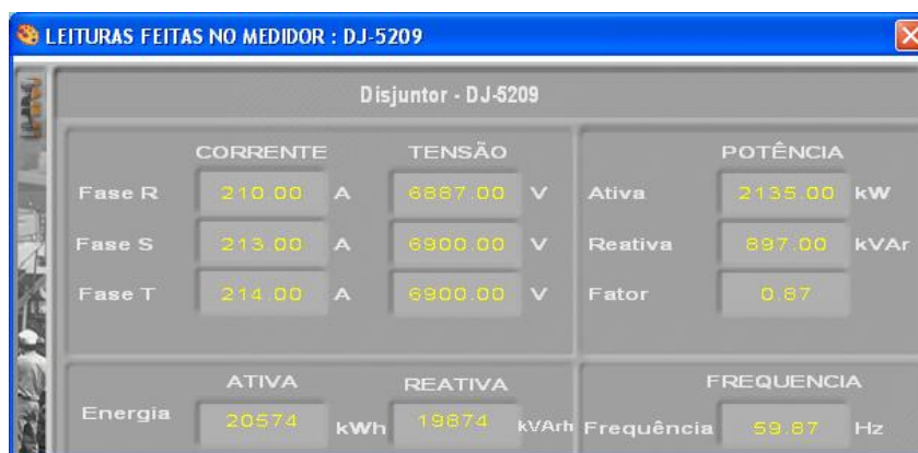
Figura 6. Tela para exibição de medições realizadas por medidor.
