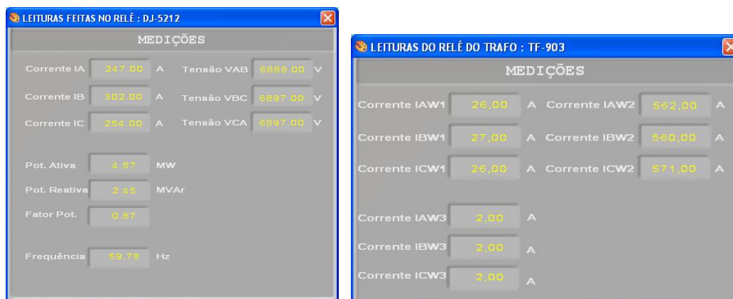
Figura 5. Telas para exibição de medições do relé.
