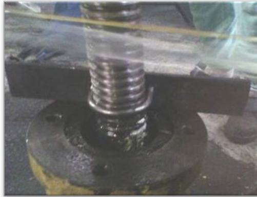
Figura 12. Detalhe do dispositivo de travamento da haste Fonte: ArcelorMittal Tubarão (2013).
