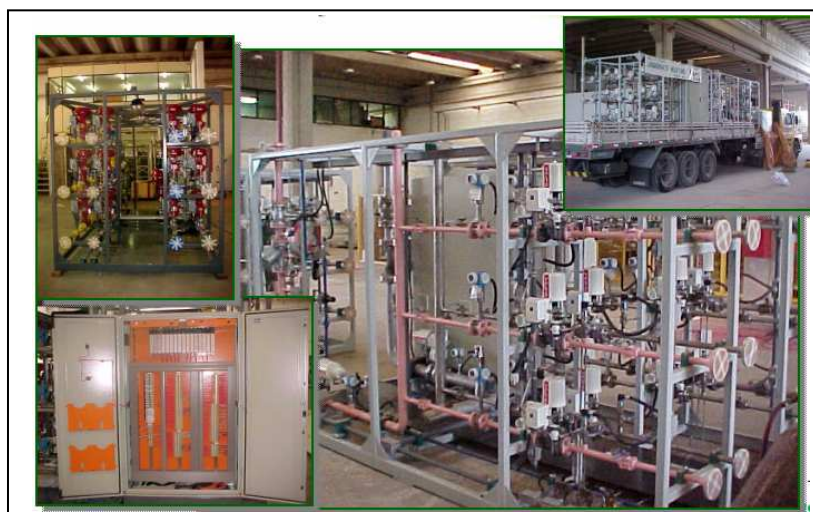
Figura 6. Rack de válvulas de um Sistema CoJet.
