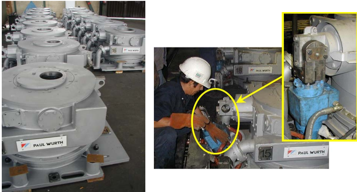
Figuras 6 e 7. Vibromolds fornecidos com M-EMS e sist. de engate rápido do cilindro.
