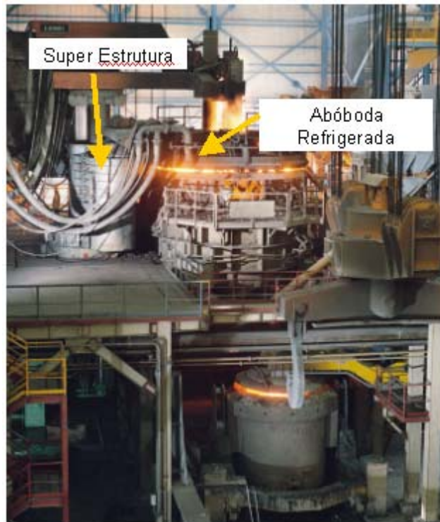
Figura 11 – Giro independente da abóboda e dos eletrodos
