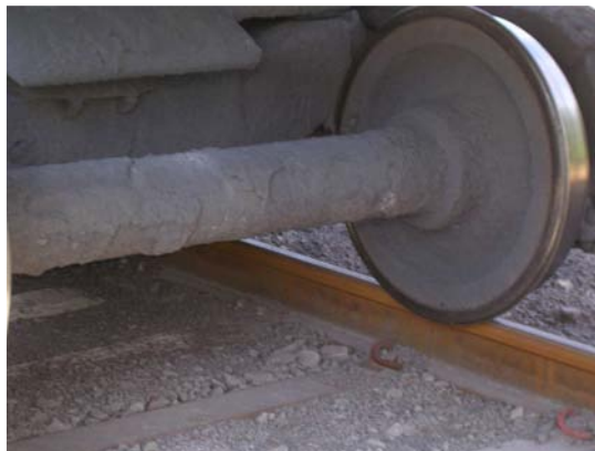
Figura 1: Eixo de carro-torpedo, com respingos de gusa e escória em sua superfície.
