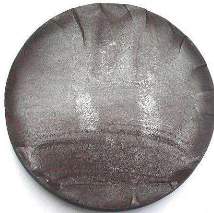
Figura 2: Superfície de fratura por fadiga de um eixo de carro-torpedo.
