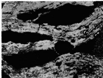
Figure 3D. Fusiform vacuoles in attrital vitrinite , 626 F.
