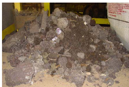
Figura 15 – Ferro gusa retirado durante a desobstrução.
