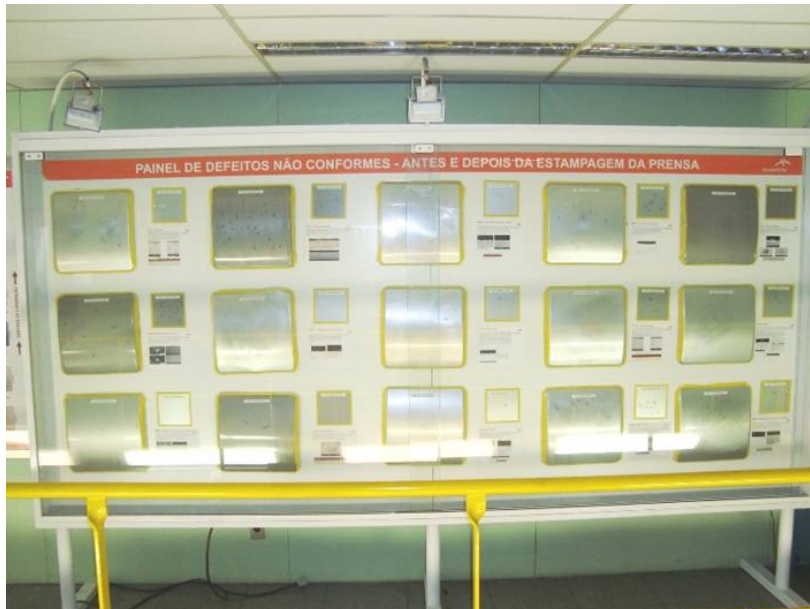
Figura 3. Painel de defeitos não conformes – antes e depois estampagem.
