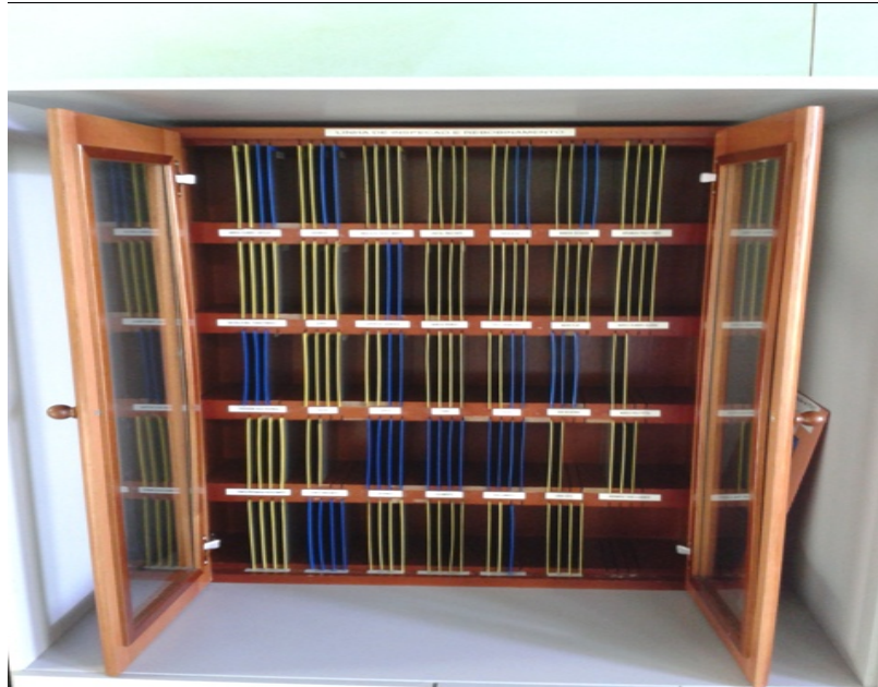
Figura 2. Mostruário padrão de defeitos superficiais.
