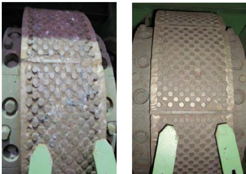
Figura 6. Camada autógena de material entre os pinos dos rolos para as amostras de itabirito compacto (esquerda) e itabirito friável (direita).
