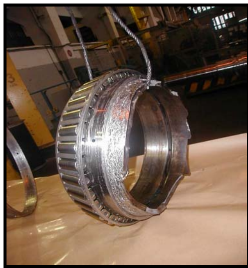
Figura 3 – Foto da falha típica de um rolamento do mandril – detalhe do cone duplo
