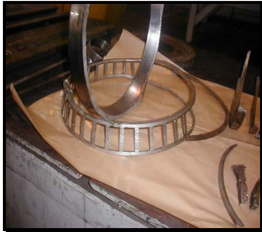
Figura 4 – Foto da falha típica de um rolamento do mandril – detalhe da capa e outros componentes
