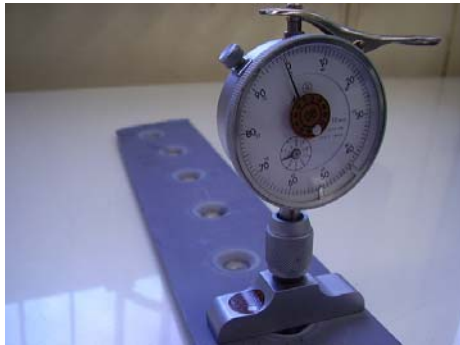
Figura 5a: Ensaio Erichsen no aço SEM revestimento IE_{21} = 8,00 mm
