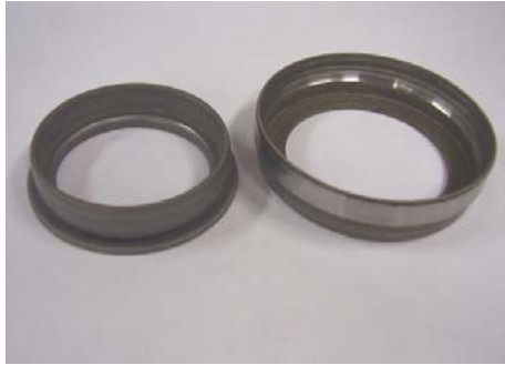
Figura 8: Anéis internos e externos em aço alto carbono fosfatizado (esquerda) e rolamento de embreagem montado (direita).
