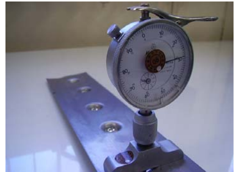
Figura 5b: Ensaio Erichsen no aço COM revestimento IE_{21} = 8,70 mm
