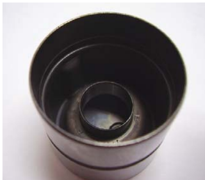
Figura 10: Tucho hidráulico aplicado em motores de automóveis.
