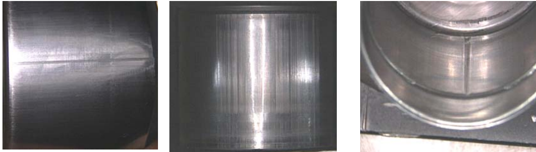
Figura 11: Exemplo de peças com riscos ocasionados pela ausência de camada de fosfato.
