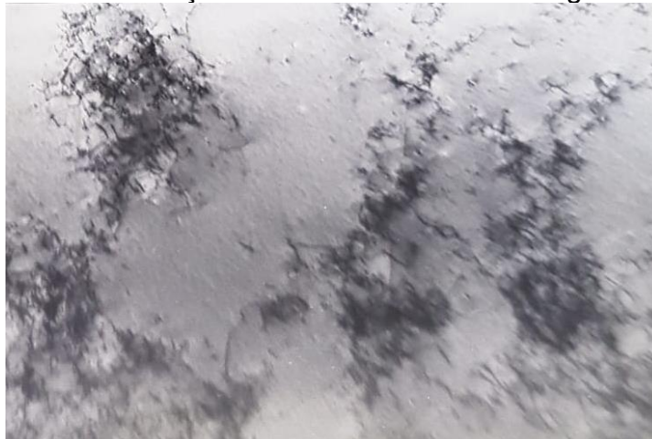
Figura 9 – Subestrutura de discordâncias para deformação cisalhante de 8% no cobre monocristalino deformado em torção a 300k.
