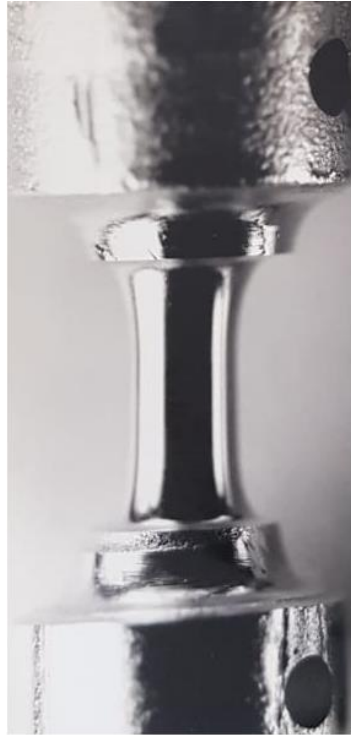
Figura 4 – Corpo de prova de cobre monocristalino retirado por eletroerosão e polido eletroliticamente para ser ensaiado em torção.
