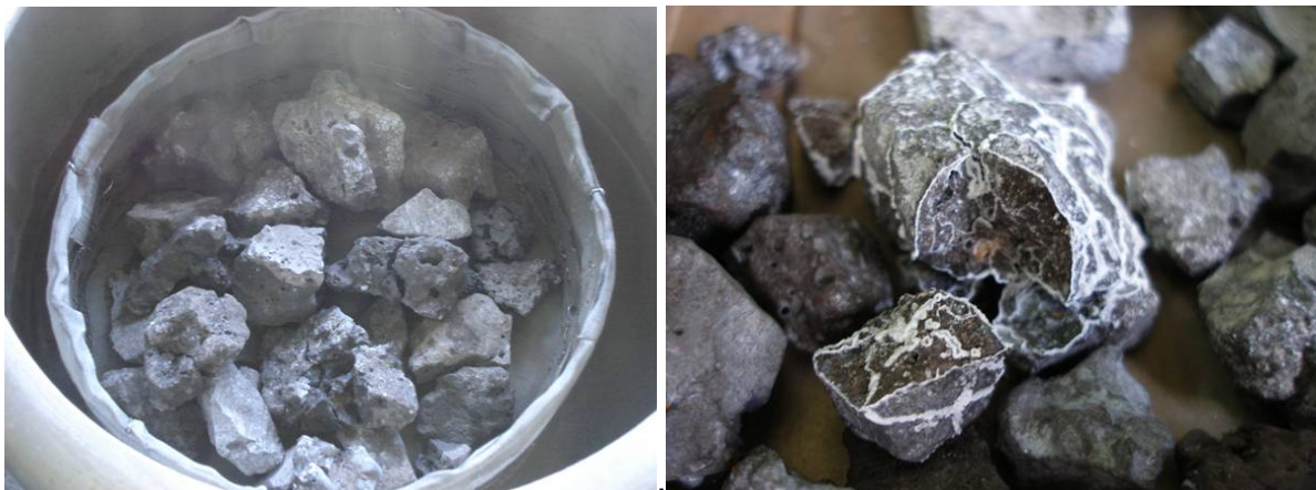
Figura 9. Tratamiento con vapor de la escoria en laboratorio IAS (izquierda) y aspecto de las piedras de escoria durante el tratamiento (derecha)
