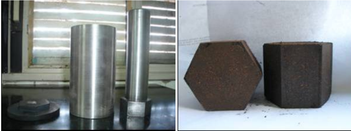
Figura 6. Molde hexagonal (izquierda) y briquetas obtenidas (derecha).
