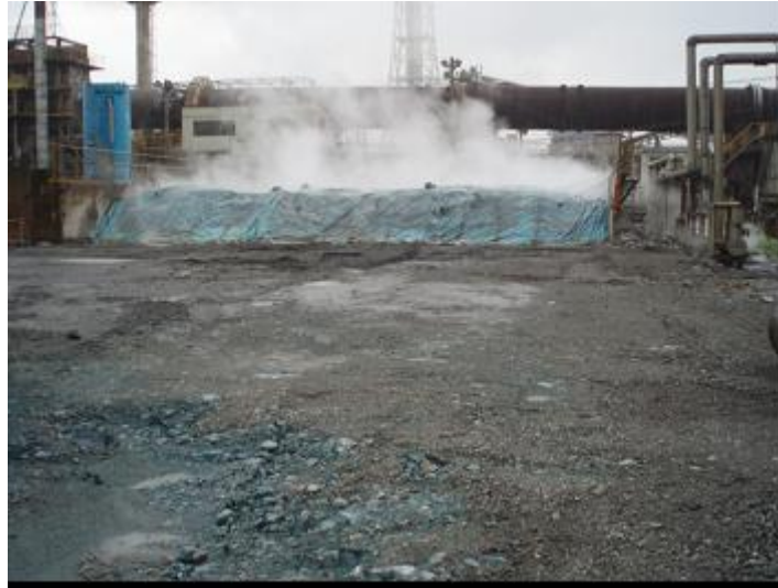
Figura 4. Processo de envelhecimento de escoria de acería com vapor.
