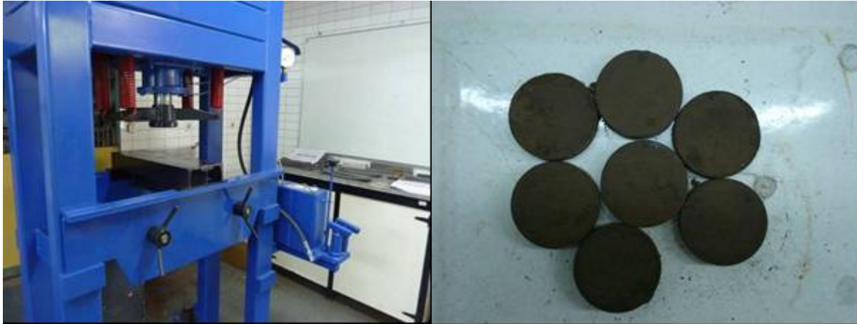
Figura 8. Prensa vertical (izquierda) y briquetas obtenidas (derecha).
