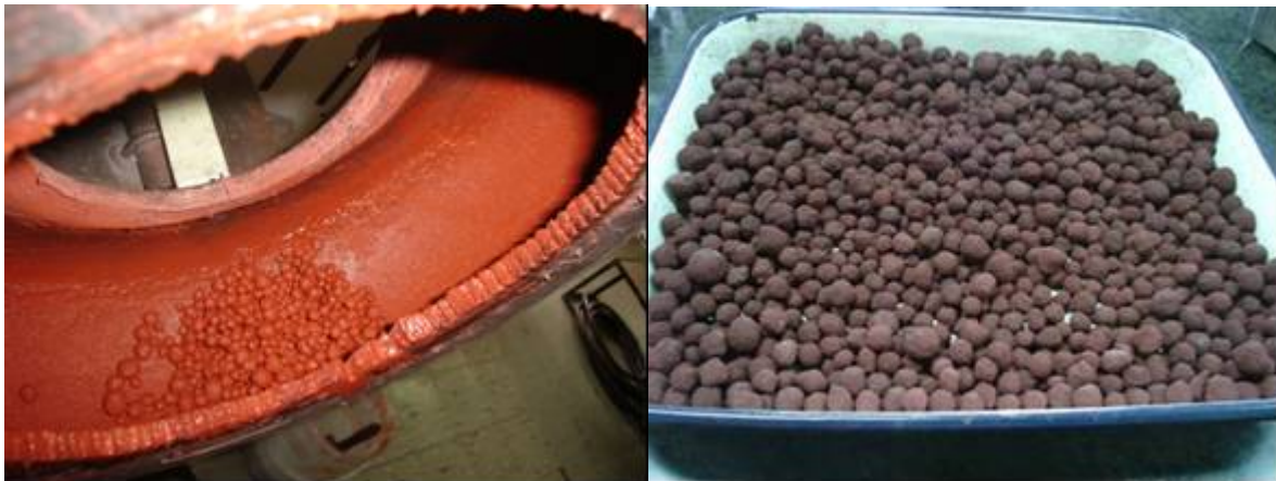
Figura 7. Dispositivo rotatorio (izquierda) y pelets obtenidos (derecha).
