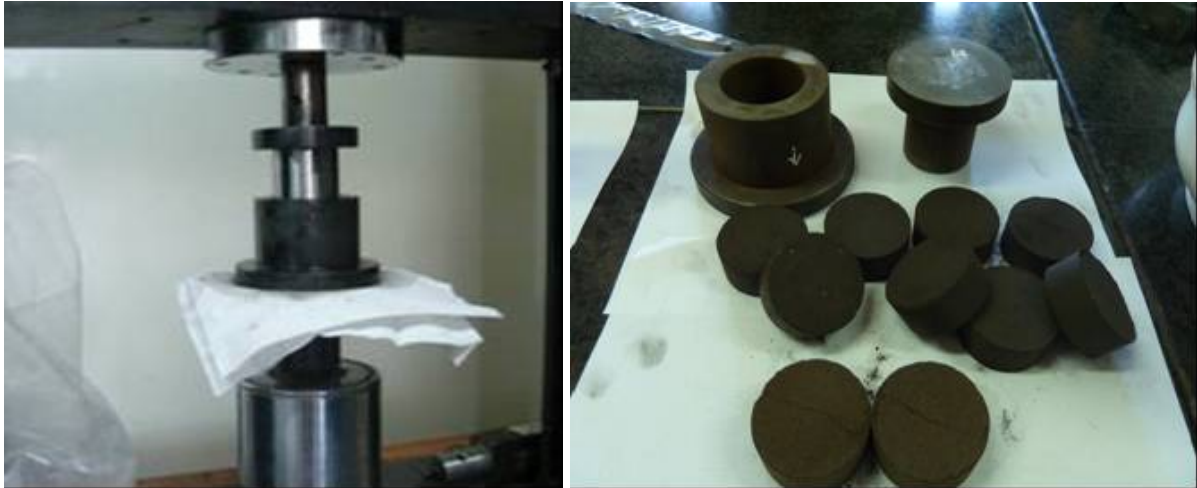
Figura 5. Ubicación en prensa vertical (izquierda) y briquetas obtenidas (derecha).
