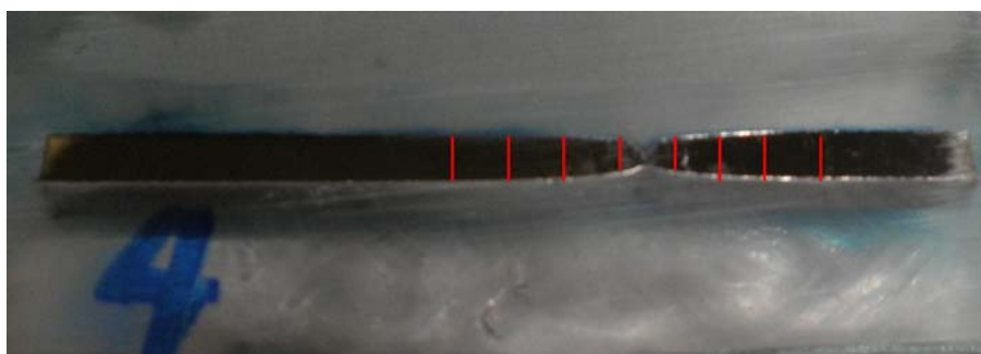
Figura 1. Corte longitudinal dos corpos-de-prova tracionados e embutidos em resina de cura a frio.
