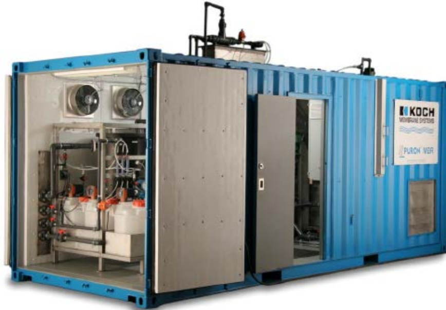
Figura 1. Planta piloto de tratamento de efluentes.
