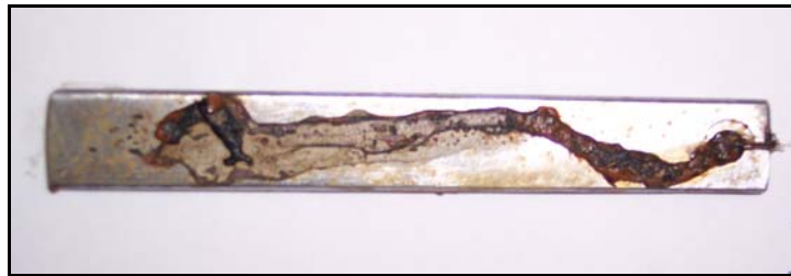
Figura 3. Depósitos de \text{Fe}(\text{OH})_3 em cupom de prova após 24 horas de exposição.
