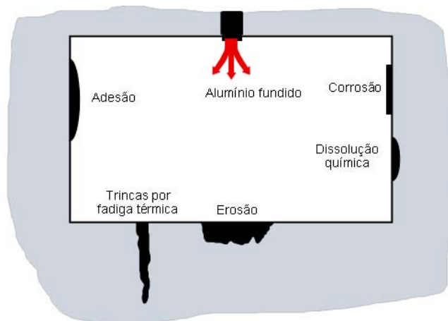
Figura 1 – Danos provocados às cavidades durante o processo de injeção de alumínio – esquemático. (1)
