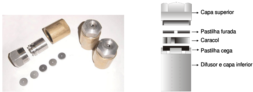
Figura 2. Partes de um Bico Pulverizador
