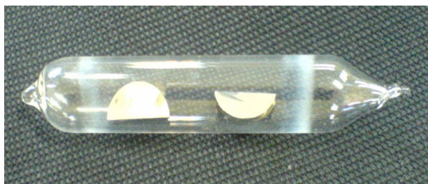
Figura 2 - Amostra da superliga MAR-M247 encapsulada em tubo de quartzo.
