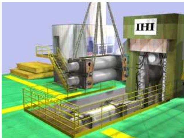
Figura 5. Troca de cilindros do LQ.<sup>(4)</sup>
