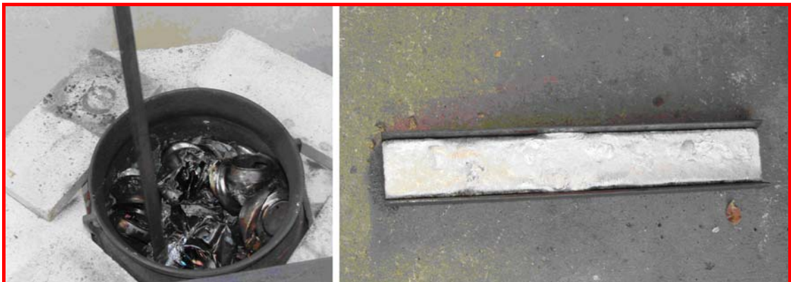
Figura 3. (a) latas de alumínio sendo fundidas e (b) aspecto do lingote confeccionado em perfil "I".
