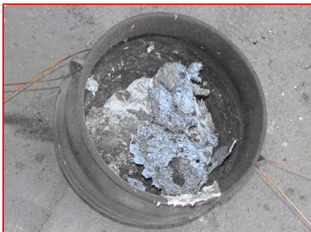
Figura 4. Aspecto da borra resultante do processo de fundição.
