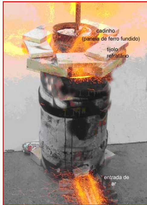
Figura 2. Forno em operação com uma corrida de alumínio.
