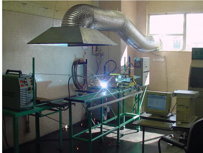
Figura 2 - Sistema automatizado de soldagem em operação.
