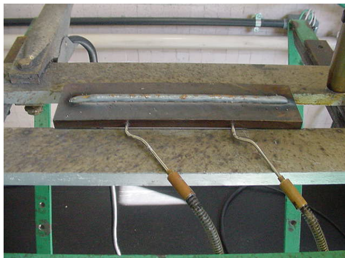
Figura 3 - Placa com o cordão de solda depositado.
