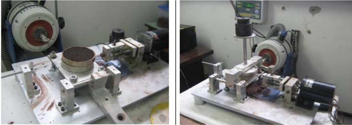
Figura 2. Célula de cisalhamento. a) preparação do material; b) ensaio em realização.
