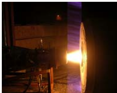
Figura 8. Zona de Combustão no modo de oxigênio quente
