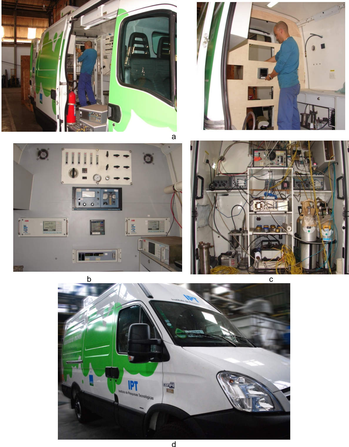
Figura 6. Unidade móvel: a - montagem da unidade; b - interior da unidade - painel com os analisadores de gases, registrador e sistema de calibração; c - interior da unidade, atrás do painel - cilindros de gases, bomba de vácuo, sistema de condicionamento da amostra; unidade móvel.
