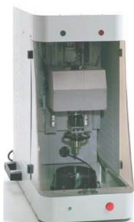
Figura 2. Equipamento e esquema de teste usado para o ensaio de microesclerometria instrumentada.
